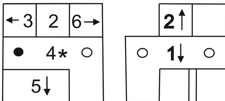
Vista superior del puzle montado, con las piezas numeradas y la dirección y sentido a seguir para extraer las seis piezas. El asterisco indica que la pieza hay que desplazarla verticalmente.
